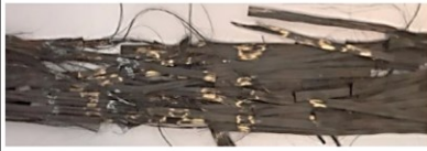
Fig. 3a. Bande continue de fibres réalignées discontinues
