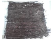
Fig. 3b. Préforme « UD » réalisée par assemblage de bandes
