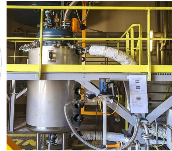
Les chutes polymérisées sont placées dans une 'cocote minute', la température est montée à 200°C, et les vapeurs de solvant dissolvent la résine qui tombent au fond de la cuve, laissant les fibres de carbone dans le tamis
